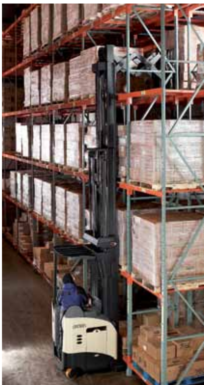
Specjalny pantograf pozwala na sięgnięcie widłami na głębokość dwóch palet. Możliwość podwójnego zasięgu dają też wózki z widłami teleskopowymi.
